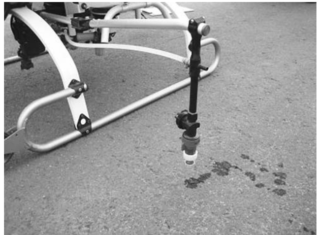
第2図 無人ヘリ用ノズル TP3349, 機体の側面の左右に1本ずつ装着されている (撮影日:2011年7月22日, 撮影場所:宮城県仙台市)
